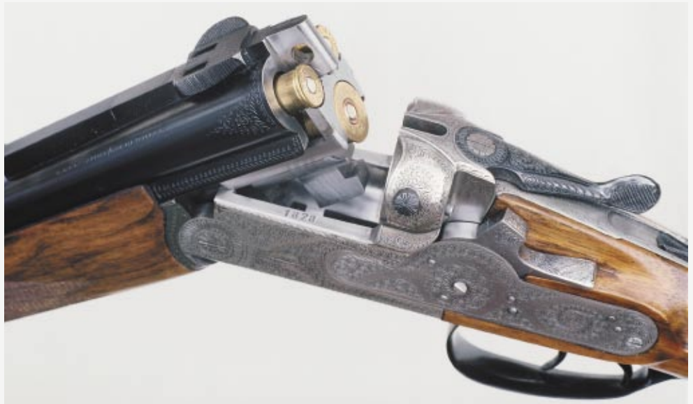
Beim Abkippen des Laufbündels werden die beiden Kronenschlosse gespannt. Das Schloss für den Schrotlauf wird zwar auch in Schlagstellung gebracht, die zugehörige Schlagfeder aber erst mit dem Spanschieber aktiviert.
