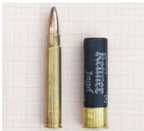
Testpatronen: Geprüft wurde die Schussleistung mit den beiden Patronensorten Kaliber 9x69 R und Kaliber 20/76 mit Schrot 3,5 mm.
