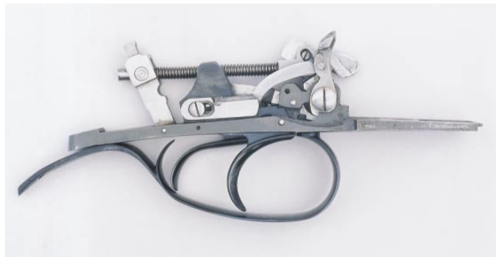
Umschaltung: Auf dem Abzugsblech ist auch die Umschaltung des vorderen Abzuges für das Auslösen der Schüsse rechts links installiert.
