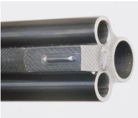
Gekeilt: Zwischen den Büchsenläufen ist der eingesetzte Keil sichtbar.
