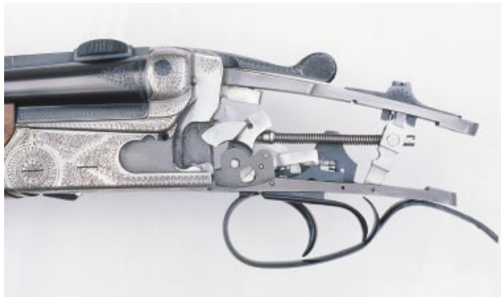
Das Blitzschloss ist auf dem Abzugsblech montiert. Das Schlagstück steht zwar in Schlagstellung, die zugehörige Feder ist aber nicht aktiviert.
