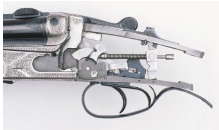
Durch Vorschieben des Schiebers auf der Scheibe erfolgt die Aktivierung der Feder. Das Schloss ist mit 1,95 kg Abdruck gut einreguliert.
