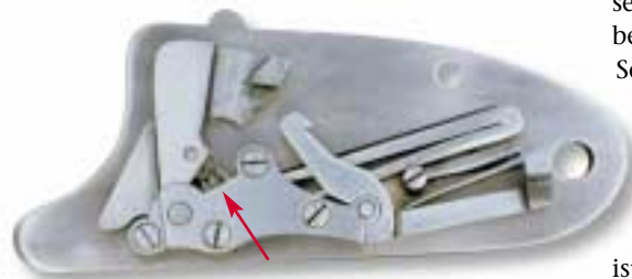
Technischer Leckerbissen: Nimrod-Seitenschlosse, bei denen zwischen oberem Schenkelfederarm und Schlagstück die Stemmreihe erkennbar ist (Pfeil). Das obere Schloss wurde abgeschlagen, das untere ist gespannt
